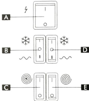
A. Interruptor principal: se utiliza para encender / apagar la maquina entera.
